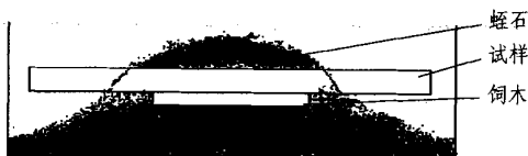
图 1 木材试样的腐朽试验方法
